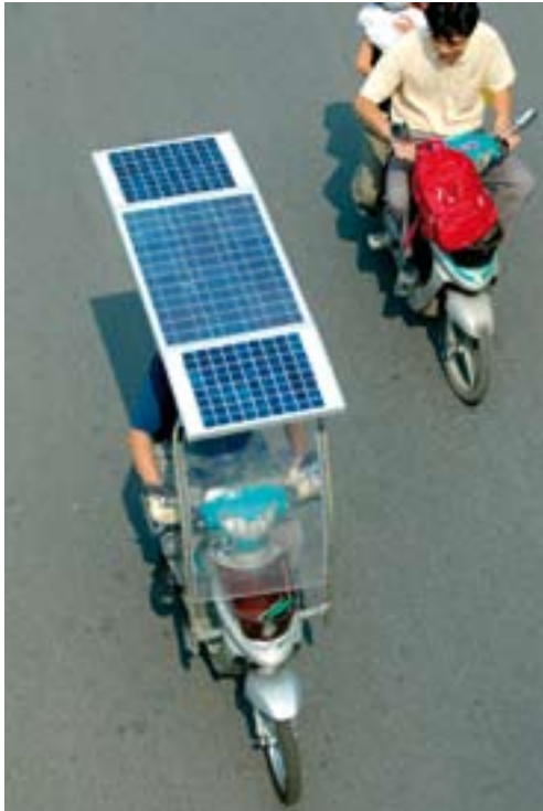
Solarbetriebenes Fahrrad in Hangzhou, China. Das Rad mit 0,6 Quadratmeter Solarzellen würde in der Serienproduktion rund 498 Euro kosten.
